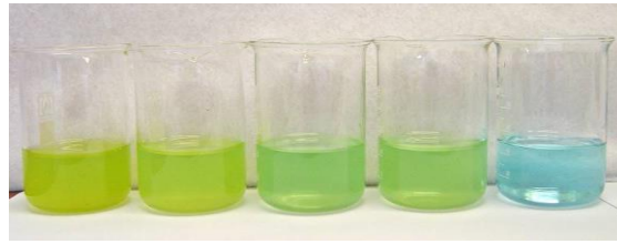
Abb.33: unterschiedliche Filtrate bei Benutzung der verschiedenen Filter v.l.n.r.: Ausgangslösung/-suspension, Kaffeefilter Mild, Kaffeefilter Classic, Kaffeefilter Kräftig, Rundfilter
