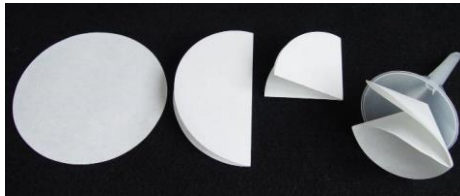
Abb.31: Faltung eines Rundfilters für die Filtration mit einem Trichter
