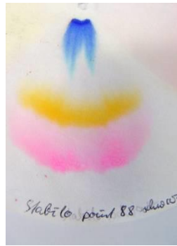
Abb.35: Chromatogramm eines Stabilo®-Fineliner „point 88“
