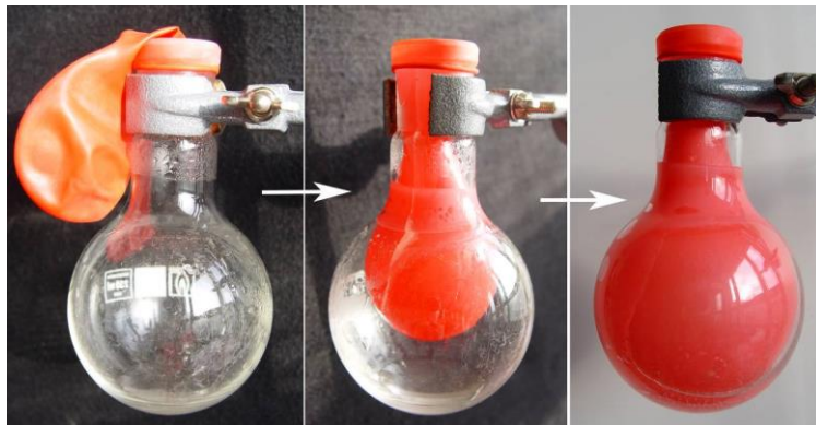
Abb. 8: ein Luftballon zieht sich durch kondensierendes Wasser in einen Rundkolben hinein
