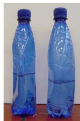
Abb. 20: Kohlenstoffdioxid löst sich in Wasser, wodurch die Flaschen einbeulen
